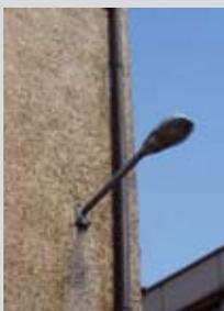
Par rapport au dispositif d'éclairage suspendu à un câble reliant deux immeubles, celui directement fixé au mur a l'avantage de mieux illuminer le bord de la chaussée. Dans tous les cas, il faut veiller à ce que l'éclairage ne gêne pas les résidents.
